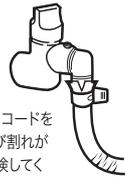
ガスソフトコードを曲げてひび割れが無い点検してください。
